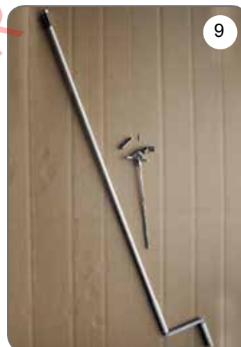
Korba, przegub Cardana 45° lub 90° z zaczepem dzwinkowym [9].
